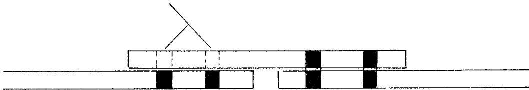
شکل ۹ - ۴۲ - روش سوراخ کردن ورق‌های اتصال.
