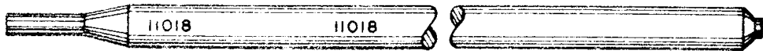
شکل ۳-۶ - محل شماره طبقه‌بندی الکتروود برای الکتروود روکش‌دار با محل گیره انتهایی (ته‌گیر).
